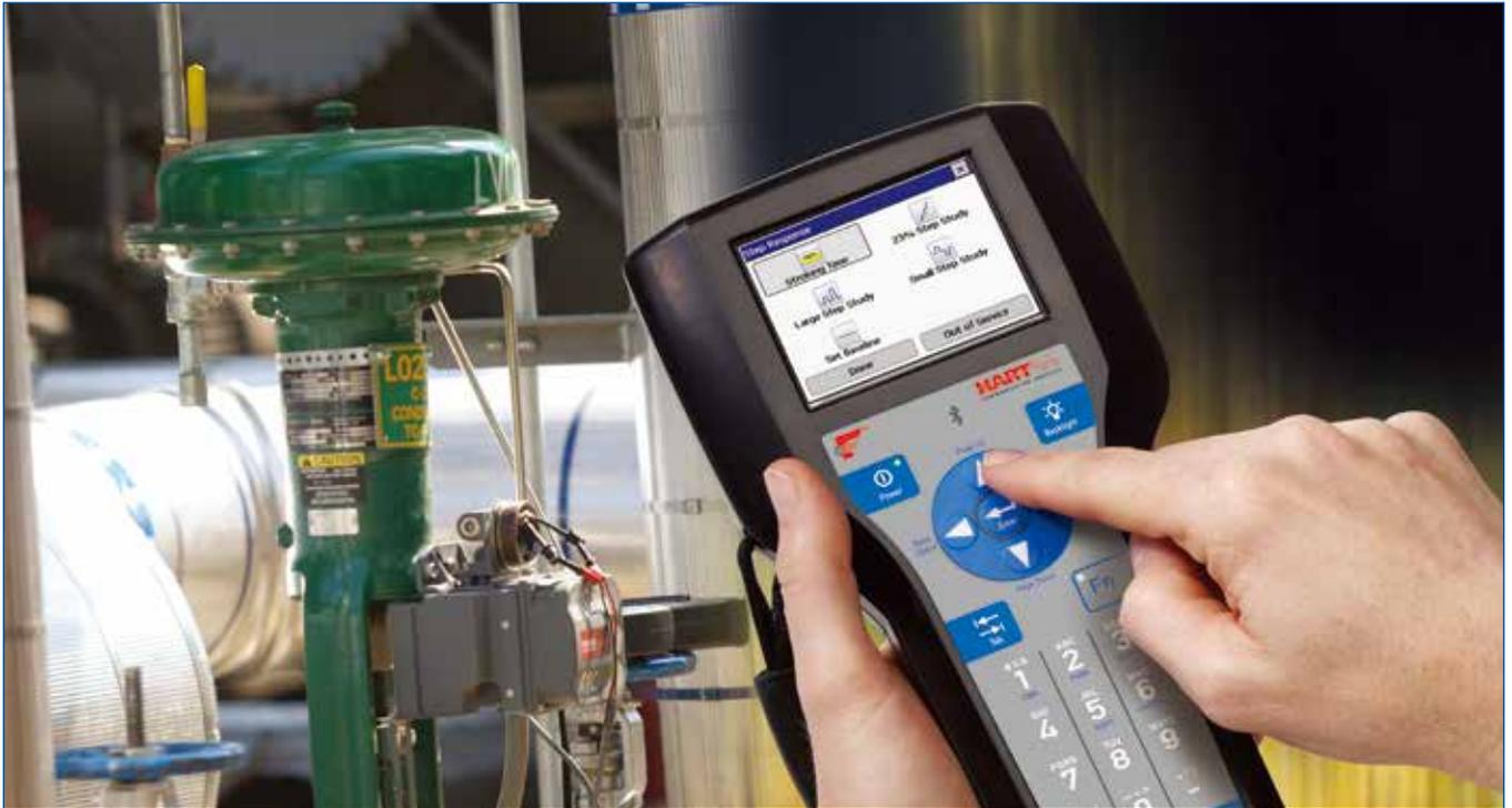
通过 ValveLink Mobile 和增强的图形功能在现场进行高级故障诊断
